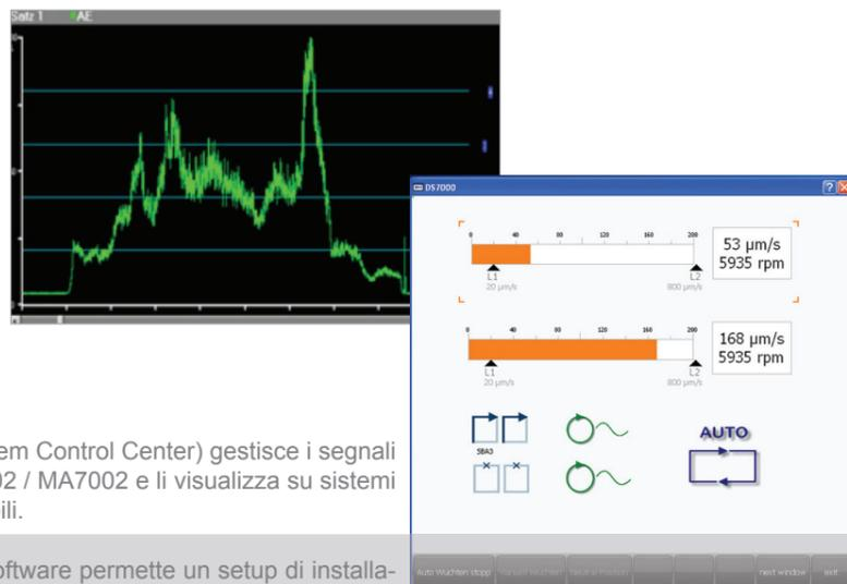
Il nuovo software USCC (Unified System Control Center) gestisce i segnali elaborati dalle unità elettroniche M7002 / MA7002 e li visualizza su sistemi a base PC Windows o Linux compatibili.
